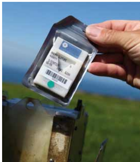
Dosimètre permettant de mesurer la radioactivité autour des centres de stockage.
