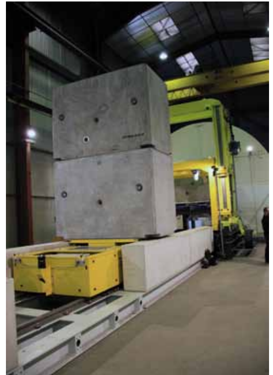
Essai de mise en place et de retrait de colis de stockage de déchets MA-VL.
