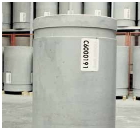
Colis béton de déchets MA-VL (1 m 50 de hauteur, 1 m de diamètre, ~ 2 tonnes).
