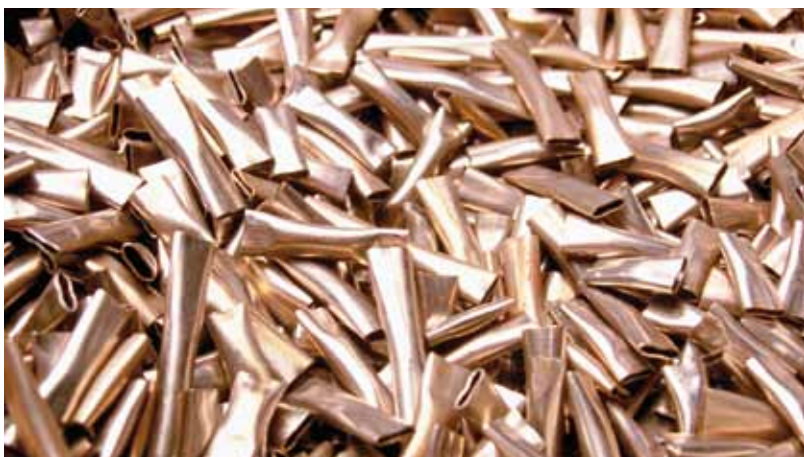
Débris métalliques issus des structures entourant les combustibles usés (coques et embouts) qui constituent des déchets MA-VL.
