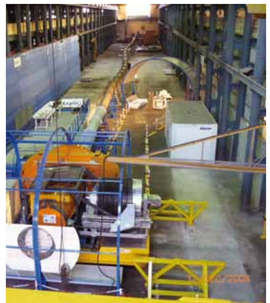
Essai de retrait d'un colis HA dans une alvéole fortement déformée.
