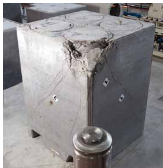
Démonstrateur de conteneur de stockage MA-VL après un essai de chute.
