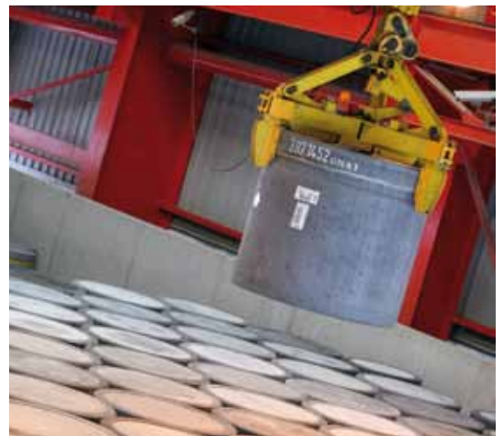
Stockage d'un colis dans une alvéole du CSA.
